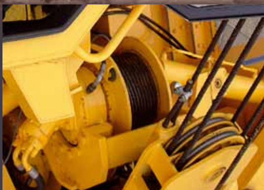
Para niezależnych wciągarek hydraulicznych kontroluje ruchy haka i wysięgnika.
