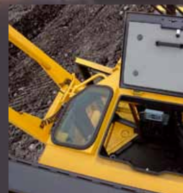
6-cio ścienna kabina wyposażona w duże okno w dachu zapewnia widok we wszystkich kierunkach. Właz wyjściowa awaryjna umożliwia opuszczenie kabiny w sytuacjach
