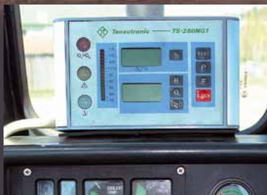
Elektroniczny ogranicznik udźwigu – montowany na życzenie, dostarcza operatorowi wszystkich niezbędnych informacji o aktualnym stanie osprzętu dźwigowego.
